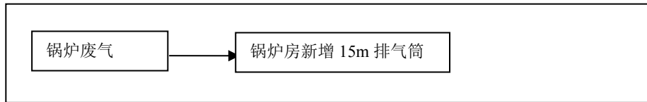
图4-4 锅炉废气处理系统流程图
