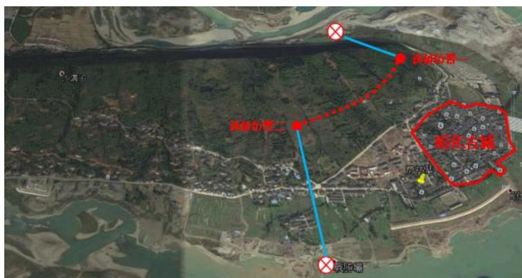
根据消防水池所需地面高程，地面高程不应低于530.00m。目前只有古城北部翼山，地势较高，高程能满足选址要求。本次两处备选位置绝对标高为530.5m，均大于530.00m。选址在530.0m的高程处与最不利点消火栓的高程差38m，分成两座，每座长宽高为21.5m\*11.5m\*4.8m，为半地下式，地下埋深2m。
